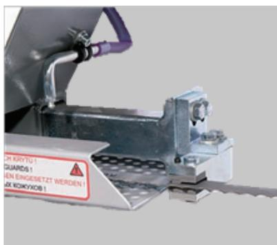
Una precisa guida a tre lati in metallo duro guida la banda della sega nel taglio. Questo sistema può essere regolato completamente in tutte le direzioni e garantisce una guida ottimale della banda di taglio.
