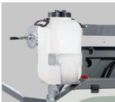
Il raffreddamento a gravità e la lubrificazione della fascia con una presa regolabile prima del taglio assicurano che la banda della sega sia in condizioni ottimali durante il taglio.
