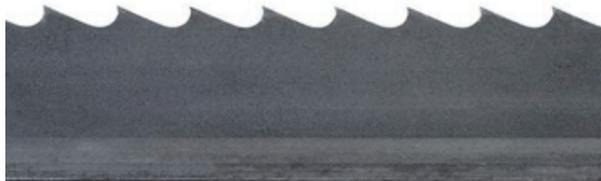
Costruite con punta dei denti in acciaio viene solitamente utilizzata per tagliare il ferro. Questa nuova tecnologia elimina la necessità di sostituire o affilare spesso la lama della sega. La lama portante è in lega di acciaio per molle con cromo e il dente è in HSS con durezza di 67 HRC. La lama è fornita nitida, incastonata e levigata.
