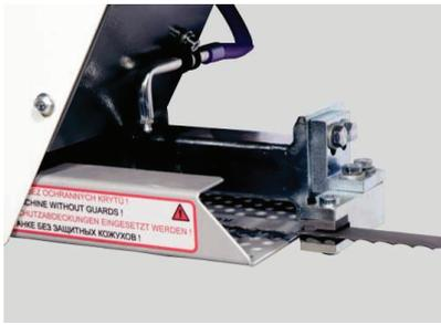
Una precisa guida a tre lati in metallo duro guida la banda della sega nel taglio. Questo sistema può essere regolato completamente in tutte le direzioni e garantisce una guida ottimale della banda di taglio.
