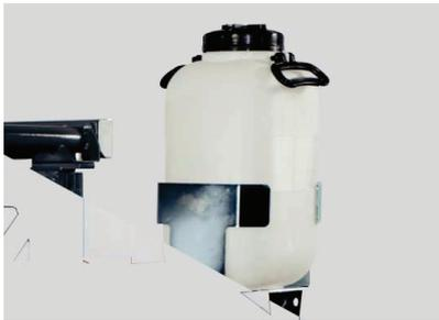
Il raffreddamento a gravità e la lubrificazione della fascia con una presa regolabile prima del taglio assicurano che la banda della sega sia in condizioni ottimali durante il taglio.
