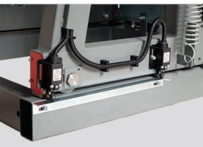
Entrambe le estremità delle guide sono fissate su entrambe le estremità contro la collisione del ponte con 2 interruttori di fine corsa. Rallenterà e dopo arresta il ponte.
