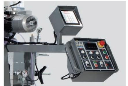
L'avanzamento e l'altezza della sega sono regolabili, e la velocità di corsa viene visualizzata sul display digitale.
