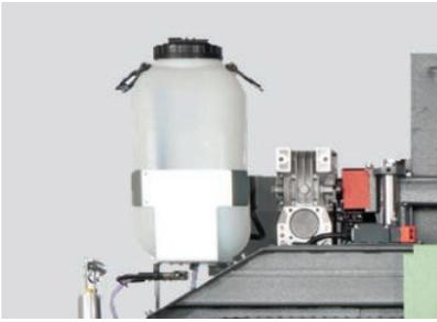
Il raffreddamento a gravità e la lubrificazione della fascia con prese regolabili su entrambe le pulegge di guida assicurano che la sega sia in condizioni ottimali durante il taglio.
