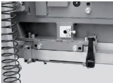
Per garantire la precisione del taglio, la puleggia di guida sul lato dell'operatore si avvicina il più possibile al pezzo da lavorare. Sistema di cuscinetti voluminosi azionato semplicemente. Può essere alimentato a motore e controllato come dispositivo ausiliario dal pannello di controllo.
