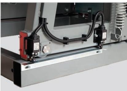
Entrambe le estremità delle guide sono fissate su entrambe le estremità contro la collisione del ponte con 2 interruttori di fine corsa. Rallenterà e dopo arresta il ponte.
