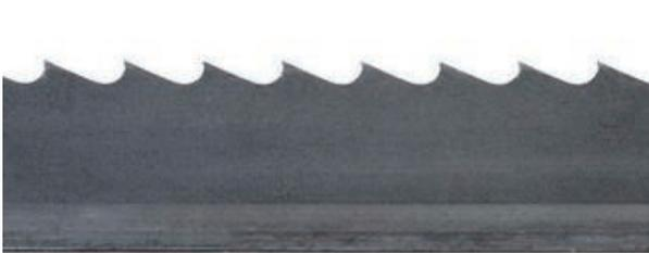
Costruite con punta dei denti in acciaio viene solitamente utilizzata per tagliare il ferro. Questa nuova tecnologia elimina la necessità di sostituire o affilare spesso la lama della sega. La lama portante è in lega di acciaio per molle con cromo e il dente è in HSS con durezza di 67 HRC. La lama è fornita nitida, incastonata e levigata. Uso: legno morbido, duro
