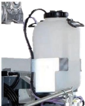
Il raffreddamento a gravità e la lubrificazione della fascia con prese regolabili su entrambe le pulegge di guida assicurano che la sega sia in condizioni ottimali durante il taglio.
