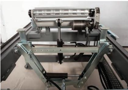
I morsetti idraulici si allineano automaticamente in base al diametro del ceppo o possono essere bloccati nella posizione desiderata. Vengono inoltre utilizzati per il bloccaggio del materiale su un lato contro arresti angolari. Tutti i morsetti sono controllati da un singolo controller.
