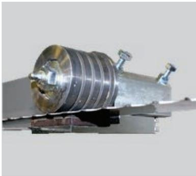
La lama della sega è guidata nel taglio da pulegge di guida temprate e rettificate. Questo sistema può essere regolato completamente in tutte le direzioni e garantisce una posizione ottimale delle pulegge di guida e della sega
