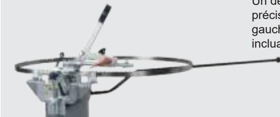
Un design robuste en fonte assure une longue durée de vie de la machine et une précision de réglage maximale. Deux dents (droite, gauche) ou trois dents (droite, gauche, droite) sont réglées en même temps avec un seul mouvement de levier. Prix incluant un indicateur de réglage de la scie. Bande de scie de 15 à 70 mm de largeur.
