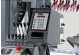
Système de mesure numérique pour un réglage automatique rapide et précis de l'épaisseur désirée de la coupe. Après spécification des réglages de base (hauteur de la zone de battage et de la découpe) et de la valeur souhaitée (épaisseur de coupe), le bras avec une bande de scie se déplace automatiquement vers la position requise. Cela empêche les défaillances induites par l'homme qui peuvent survenir lors des réglages de coupe manuelle. Gain de temps, refile la production.
