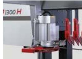
La circulaire de pré-coupe avec des pointes en métal dur est conçue pour enlever la saleté aux endroits où la lame de scie coupe dans la bûche. La lame de scie ne s'émousse pas rapidement. Les échanges fréquents de la lame de scie sont réduits, la durée de vie de la lame de scie et la productivité de la machine augmentent.
