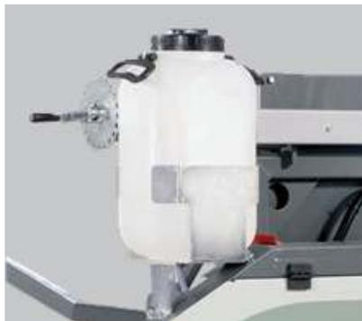
Refroidissement par gravité et la lubrification de la bande avec une sortie réglable avant la coupe garantissent que la bande de la scie est dans des conditions optimales pendant la coupe.
