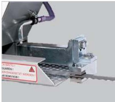
Guidage précis en métal dur à trois côtés guide la bande de scie dans la coupe. Ce système peut être entièrement ajusté dans toutes les directions et assure un guidage optimal de la bande de scie.
