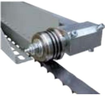
La bande de scie est guidée dans la coupe par des poulies de guidage trempées et rectifiées. Ce système peut être entièrement ajusté dans toutes les directions et assure une position optimale des poulies de guidage et de la bande de scie.
