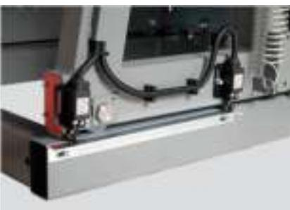
Les essuie-glaces en feutre permettent un nettoyage précis des bandes de rail.
