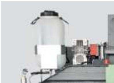
Le refroidissement par gravité et la lubrification de la bande avec une sortie réglable avant la coupe garantissent que la bande de la scie est dans des conditions optimales pendant
