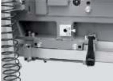
Au fin d'assurer la précision de la coupe, la poulie de guidage du côté de l'opérateur se rapproche le plus possible de la pièce. Système de roulement massif actionné simplement. Il peut être alimenté par moteur et contrôlé comme un dispositif auxiliaire à partir du panneau de commande.
