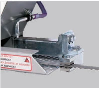
Una guía precisa de metal duro de tres lados guía la banda de sierra en el corte. Este sistema se puede ajustar completamente en todas las direcciones y garantiza una guía óptima de la banda de corte.
