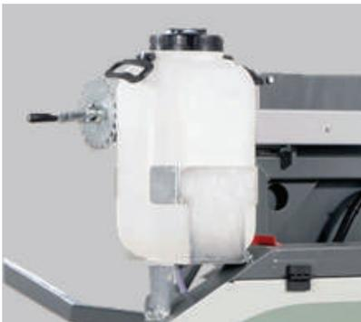
La refrigeración por gravedad y la lubricación de la correa con un casquillo ajustable antes del corte aseguran que la banda de la sierra esté en condiciones óptimas durante el corte.
