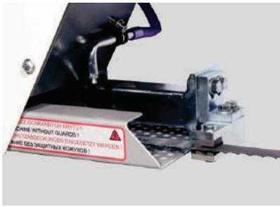
Una guía precisa de metal duro de tres lados guía la banda de sierra en el corte. Este sistema se puede ajustar completamente en todas las direcciones y garantiza una guía óptima de la banda de corte.
