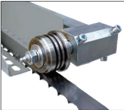
La banda de sierra es guiada en el corte por poleas de guía endurecidas y rectificadas. Este sistema se puede ajustar completamente en todas las direcciones y asegura la posición óptima de las poleas de guía y la banda de sierra.
