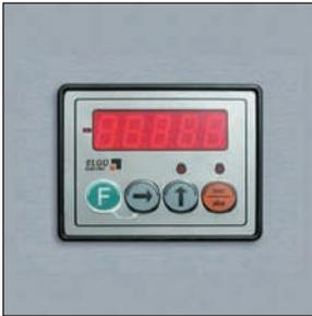
Está diseñado para un ajuste rápido y preciso del espesor requerido de la placa. El movimiento del brazo de la sierra de cinta hacia arriba y hacia abajo se muestra con una precisión de 0,1 mm en una pantalla a color. La fuerza absoluta desde la banda de la sierra de cinta o, después del restablecimiento, se muestra el espesor de la placa de montaje, incluido el grosor de corte opcional
