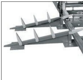
Proporciona una manipulación fácil y segura en vigas transversales de máquina con sistema de paradas exhibibles
