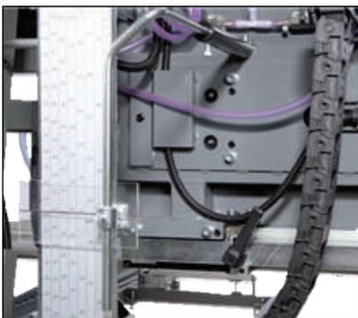
Para garantizar la precisión del corte, la polea de guía del lado del operador se mueve lo más cerca posible de la pieza de trabajo. Sistema de rodamientos masivo simplemente operado. Puede ser alimentado por motor y controlado como un dispositivo auxiliar desde el panel de control.
