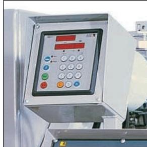
Sistema de medición digital para un ajuste automático rápido y preciso del grosor deseado del corte. Después de la especificación de los ajustes básicos (altura desde el área de carga y corte) y del valor deseado (grosor del corte), el brazo con una banda de sierra se moverá automáticamente a la posición requerida. Eso previene las fallas inducidas por el ser humano que pueden surgir durante las configuraciones de corte manual. Ahorra tiempo, refina la producción.
