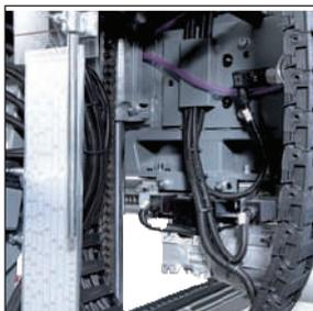
Ajuste de la barra de guía deslizante de la hoja de sierra en función del diámetro de registro controlado eléctricamente desde la mesa de control central.
