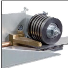
El sistema de enfriamiento consiste en una bomba de presión en el tanque de refrigerante, una válvula de solenoide de control de flujo y chorros de dos vías que rocían la banda de sierra tanto desde abajo como desde arriba. El enfriamiento de dos lados previene la tensión indeseable en la banda de la sierra y la adhesión de la resina desde debajo de la banda de la sierra y ayuda a mantener una operación más estable de la banda de sierra, un corte más preciso y una mayor vida útil.
