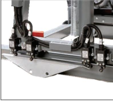
Ambos extremos de las secciones en ejecución están protegidos contra la colisión del puente de brazo con un par de interruptores de límite. Se ralentiza el puente automáticamente y luego se detiene.
