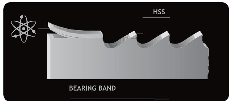
Hojas de bimetàlicas con la punta de los dientes de acero, generalmente utilizada para cortar metal. Este tipo de hoja elimina completamente la necesidad de afilarla y reemplazarla con frecuencia. Ustedes recibirán la hoja ya afilada.
