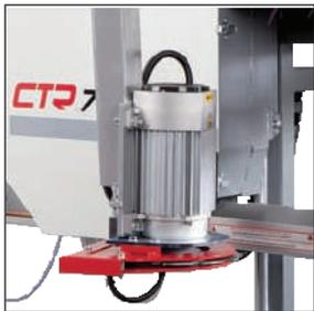
El precorte circular con puntas de metal duro está diseñado para eliminar la suciedad en los puntos donde la hoja de sierra se inserta en el tronco. La hoja de sierra no se rompe rápidamente. Los intercambios frecuentes de hojas de sierra se reducen, la vida de la hoja de sierra y la productividad de la máquina aumentan.
