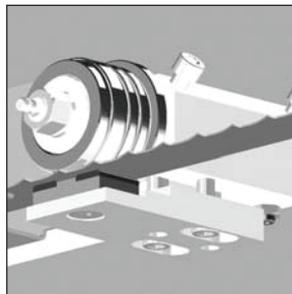
Está ubicado en el riel móvil antes del corte. Significativamente mejora la estabilidad de la banda de sierra en el corte y también en su limpieza. Por lo tanto, aumenta la productividad de la máquina y la precisión del corte. Esta máquina se puede instalar en un riel controlado eléctricamente.
