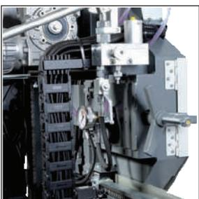
Operado por una bomba de mano hidráulica con indicación de presión precisa. El esfuerzo de la hoja de sierra es más preciso y conveniente
