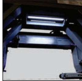
Iluminación LED (11 W)
