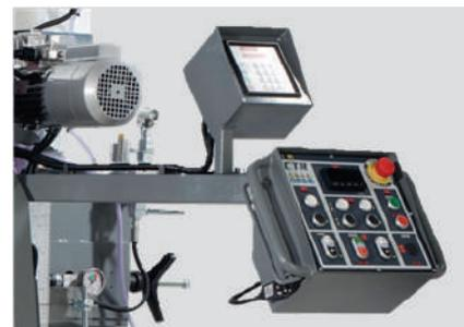
La alimentación y la altura de la sierra son ajustables, y la velocidad de desplazamiento se muestra en la pantalla digital. El panel de control se coloca en el puente móvil del brazo, para permitir que el operador trabaje lo más cerca posible de la pieza a cortar.
