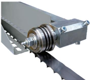
La hoja de sierra se guía en el corte mediante poleas guía endurecidas y rectificadas. Este sistema se puede ajustar en todas las direcciones y asegura una posición óptima de las políticas guía y la sierra
