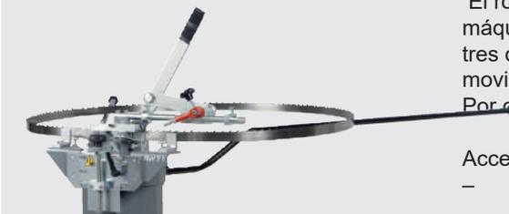
El robusto diseño de la rectificadora RW 71 hierro fundido asegura una larga vida de la máquina y la precisión máxima de la configuración. Dos dientes (derecha, izquierda) o tres dientes (izquierdo, derecho, recto) se establecen en el mismo tiempo con un solo movimiento de la palanca. La máquina está equipada con un indicador para el ajuste. Por cintas hasta un ancho de 15 a 70 mm
